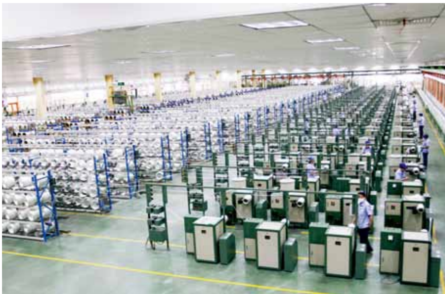
玻璃纤维生产络纱区
